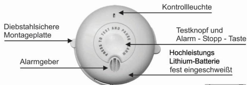
**Erster Rauchwarnmelder mit VdS-zugelassener Klebmontage mittels Spezialklebepad !!!**
